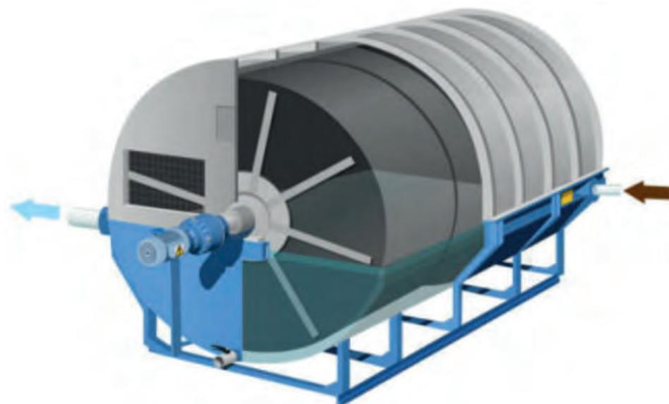
La biomasa en exceso se desprende de los discos y se retienen en los sedimentadores secundarios, desde donde se bombea hasta el sistema de tratamiento de lodos.
