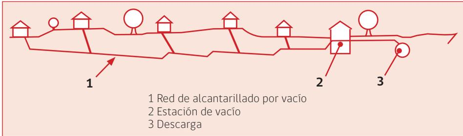
El sistema está compuesto por cámaras domiciliarias que pueden recibir a una o más viviendas, las que están conectadas a una cañería en presión negativa mediante una válvula normalmente cerrada.
